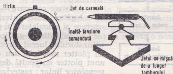
Fig. 3.9. Principiul plotterului cu jet de cerneală („ink-jet“).
